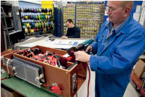
Alle onderdelen worden vooraf geassembleerd en op maat gemaakt. Hier zet de monteur de start-hulpinstallatie in elkaar. Alle draden zijn dan al op maat gemaakt met de juiste aansluitingen. Het is dan nog slechts een kwestie van 'boutje/moertje' en het onderdeel zit in het voertuig.
