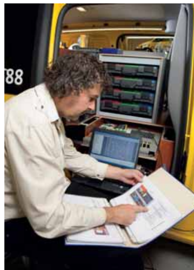
De starthulpinstallatie en onder andere de flitsers in de voorbumper, worden via een PLC aangestuurd. Met een laptop wordt de software geladen, de wegenwachter hoeft enkel een functie te activeren, de PLC staat borg voor de juiste uitvoering.
