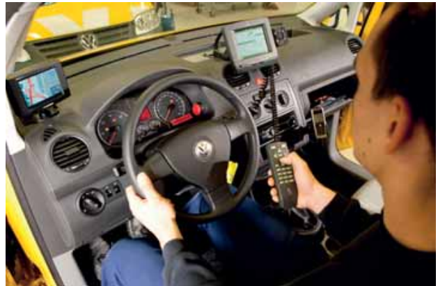
De communicatiehulpmiddelen zijn nog hetzelfde als in de Touran, een scherm waarin de opdrachten via de Centrale verschijnen en waarop de wegenwachter zijn status intoetst, een mobiele telefoon en een navigatiesysteem dat automatisch gevoed wordt. Volgend jaar verwacht men een systeem te introduceren waarmee draadloos documenten verstuurd kunnen worden en eventueel uitgeprint.
