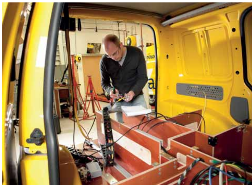
Alle elektriciteitsdraden worden weggewerkt onder de vloer zodat de wegenwachter er geen last van heeft. De meubeldelen bestaan uit verschillende segmenten die met slagmoeren aan elkaar worden bevestigd.
