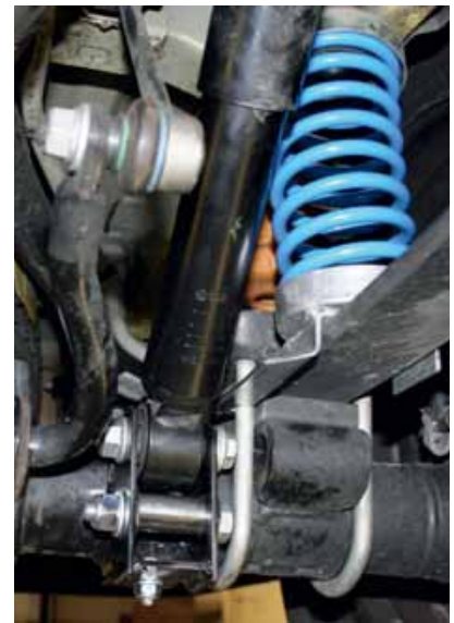
Omdat de Caddy in bedrijf eigenlijk altijd tot aan zijn maximum laadvermogen is volgestouwd, is de achteras voorzien van hulpveren. Maar omdat de auto dan 2 tot 3 cm hoger op zijn pootjes kwam te staan werkten de schokbrekers in een 'verkeerd' werkgebied waardoor de kont ging deinen. Dat is opgelost door deze 2 tot 3 cm hoger op de as te bevestigen.
