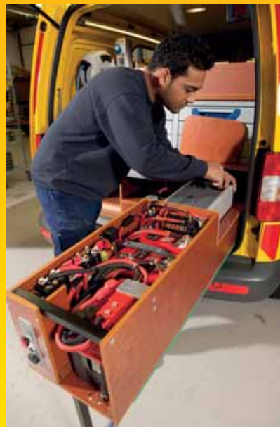
De hardware van de starthulpinstallatie is uitschuifbaar en daardoor goed toegankelijk voor onderhoud en gemakkelijk uit te wisselen. In de kist zijn drie Optima-accu's opgenomen. Eén 12 Volt-versie is op eenvoudige wijze uit de kist te halen zodat de wegenwachter ook op moeilijk te bereiken locaties starthulp kan bieden. Dit vereist dan wel handbediening!
